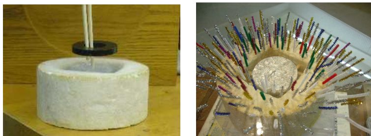
図8 . 超伝導現象の演示。磁石の反発(左)とマイスナー効果(右)
