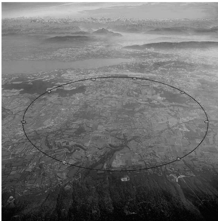
図7 .LHC(大型ハドロン衝突型加速器)。スイス・ジュネーブ郊外のCERN(欧州合同素粒子原子核研究機構)の装置。図示された円形軌道(全周27km)のトンネル内で、陽子をほぼ光速まで加速し(7TeV)、正面衝突させる。その時の反応からヒッグス場の証拠を探す。背景にアルプス山脈が見える。 CERN
