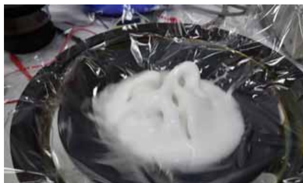
写真3. 水溶性片栗粉と、周波数、また音の大きさをうまく調整すると、片栗粉が踊りだす。
