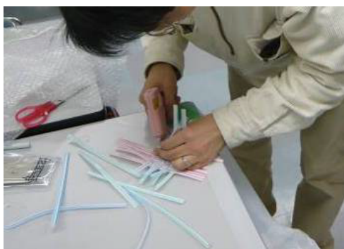
写真5. 接着用として人気があった「グルーガン」。これもプラスチックを熱で融かして押し出し、冷えて固まるという熱可塑性の特長を活かした接着方法。
