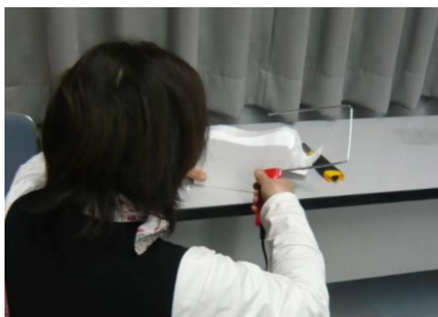
写真4. 「スチロールカッター」は、熱を加えながら切る道具。ポリスチレンが熱可塑性樹脂であるからこそ可能な方法。カッターよりもかんたんに美しく切れるので、やがてカッターは右に置かれたままに。
