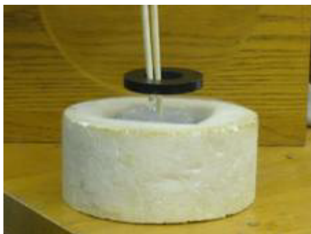
図1. 高温超伝導体がネオジム磁石を反発する様子
