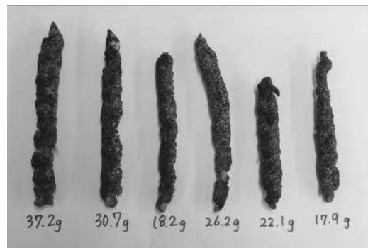
図15. 大阪市立科学館で保管しているスティックラック6本の重量の測定結果
