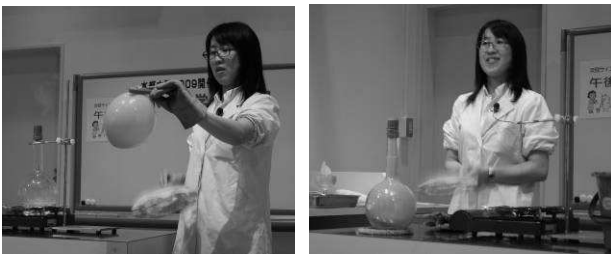
図3. 水蒸気⇄水の体積変化を確認する実験。水蒸気で膨らませた風船に栓をしてうちわで扇いで冷やすと風船がしぼみ、中には水が(左)。水蒸気で満たしたフラスコを風船で蓋し、うちわで扇いで冷やすと風船はフラスコの中に入り込む(右)。再度加熱すると、風船はもとに戻る。
