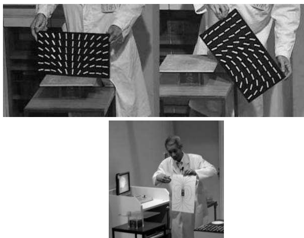
図 4. クリップ型磁力線観察装置(上)とイラストを使った説明(下)
