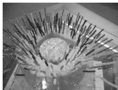
図 7. 超伝導体による磁力線の排除
