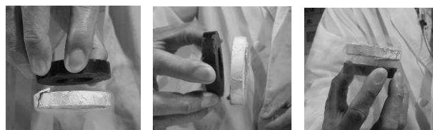
図2. 超伝導体と磁石の相対的距離が固定される。
