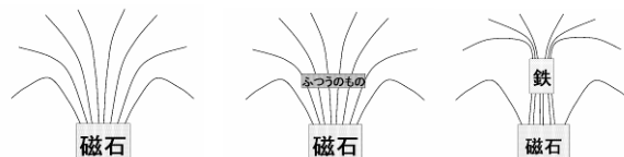
図 5. 磁力線が鉄(ハンマー)の一方に流れ込み他方から流れ出すことを示す現象と図
