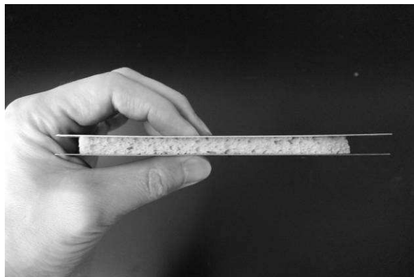
図1. 使用したセルローススポンジ(上)と金属板で挟んだ状態(下)。程良い厚みのため、金属板同士の接触がなくなる。
