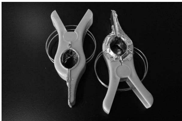
図2-1. 電極とする備長炭を挟み込む、大型の洗濯ばさみにアルミテープを巻き、導通できるようにしたもの
