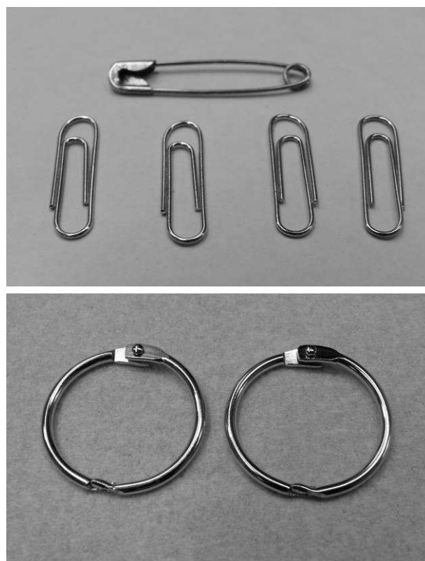
図5. クリップ(上)。全て金メッキ済み。 リング(下)。本図では分かりにくいですが、左は金メッキ前のもの。右は、金メッキ後のもの。
