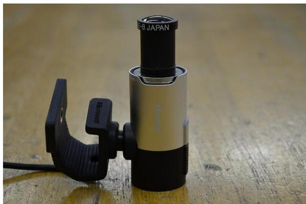
写真 1 Web カメラに魚眼コンバージョンレンズを取り付け
