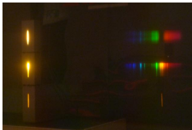
写真7. ナトリウム灯のスペクトル 下から、低圧ナトリウム灯、高圧ナトリウム灯（高効率タイプ）、高圧ナトリウム灯（高演色タイプ）
