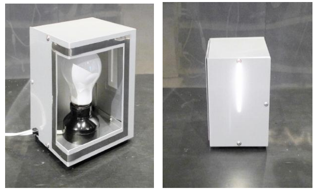
写真4. スリット付きケース(左は裏側、右は点灯時)
