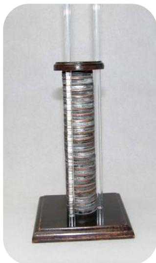
写真1. 当館で所蔵しているボルタ電池模型。
