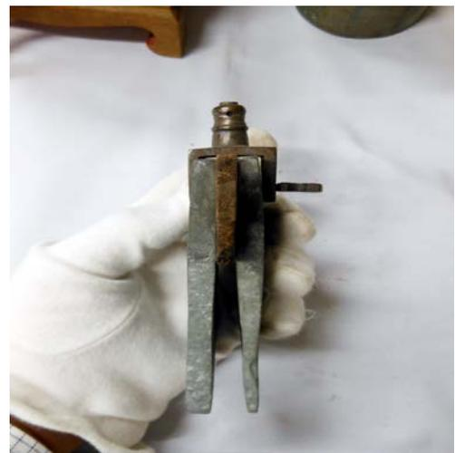
写真4. 負極側電極 亜鉛
