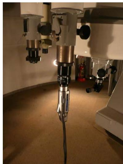
写真1 高速度カメラと望遠鏡の接続
