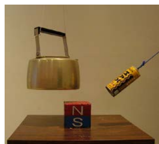
図2 10cm角ネオジム磁石。スチール缶は引き付けられるがアルミのヤカンには反応しない。
