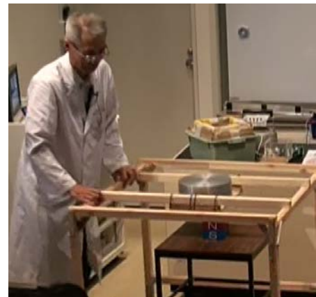
図6 アルミ塊(10cm×φ30cm)と10cm角ネオジム磁石との相互作用
