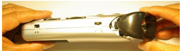
写真17. ライトカバーの下側を先に差し込む
