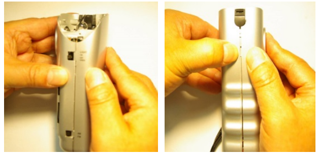
写真15. 先にケース上側を合わせ(写真左)、ケースを裏返し左側を押し込み右側の爪を押し込む
