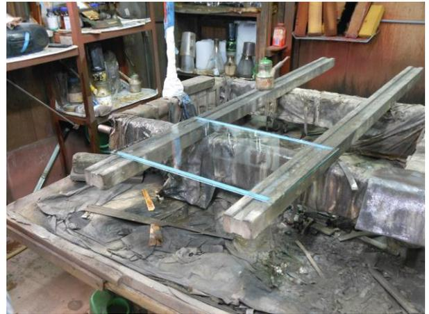
図1. 酸化鉄などを利用してガラス表面を磨き、水による洗浄が終わったところ。
