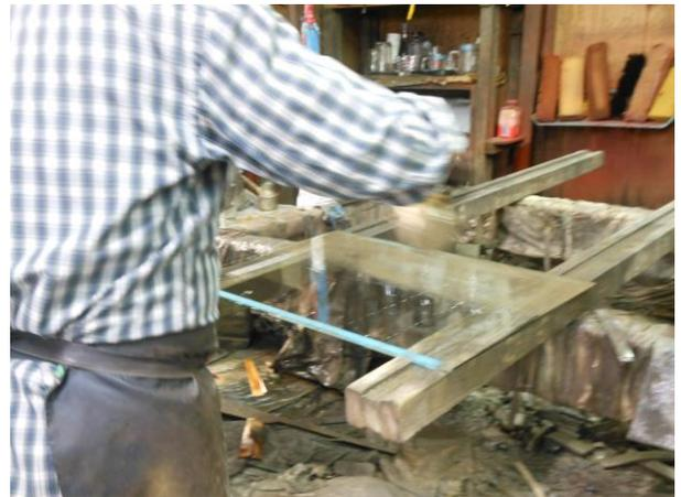
図2. ブドウ糖、硝酸銀、水酸化ナトリウムを一つの容器に入れそれをガラス面にかけている様子。気温、室温とも高温のため、即座に反応が始まる。
