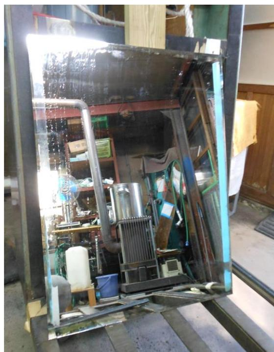
図7. 幅約 60cm×高さ 90cmの一枚ものの鏡。水滴で左側が濡れているが、映っている像にゆがみ、にじみなどはまったくない。
