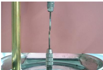
火坑(本文参照)はできないが、放電させると先端が尖ってくる。先端は赤熱し、放電後みると白い灰が付いている。
