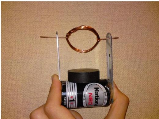
図 5-1: コイルモータ完成図
