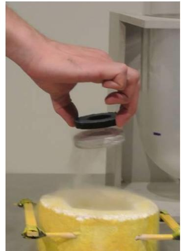
割りばしをガイドにしてやると超伝導体の上でリング磁石を浮かせることができた。磁石の上下をひっくり返しても浮かせることができる。
