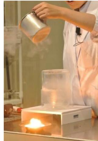
灰皿に固く丸めたティッシュペーパーに火を付けると熾火のように燃える。そこにこの液体を滴らせると激しく燃焼することから、液化した酸素であることが確認できる。
