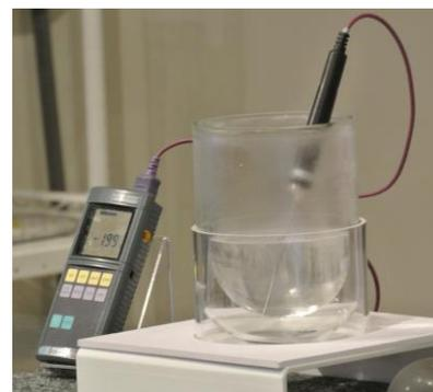
保存用のデュワー瓶から演示用の透明デュワー瓶に液体窒素を移し、ゴボゴボと激しく沸騰する様子も見ていただいた。また、デジタルで温度を表示できる熱電対があったので、液体窒素の温度を測った。
