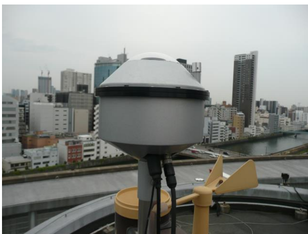
写真5 屋上に設置した全天カメラ
