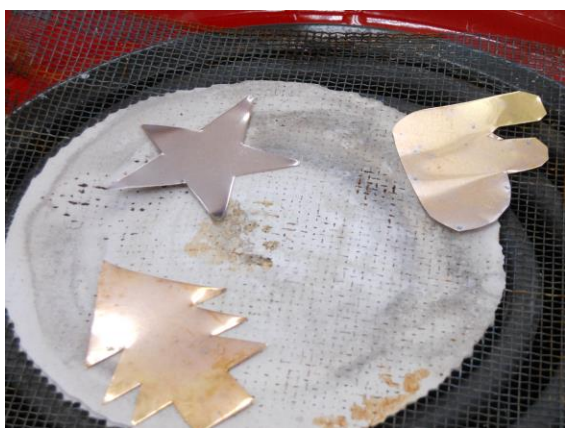
図3. 電熱器上の銅板。亜鉛がめっきされた後の状態のものを、電熱器で加熱すると表面が真鍮に変化する。
