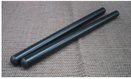
図5. エボナイト製の手軽な摩擦静電気の実験道具。別の素材と擦ると静電気を発生。現代の理科実験用具。
