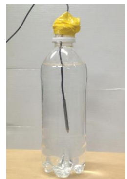
写真2. ペットボトルに入れた温度センサー
