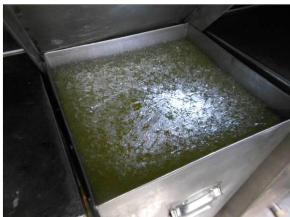
図 8. 缶の中のほとんどの液体が、 $\alpha$ -メントールとして結晶化した状態のもの。
