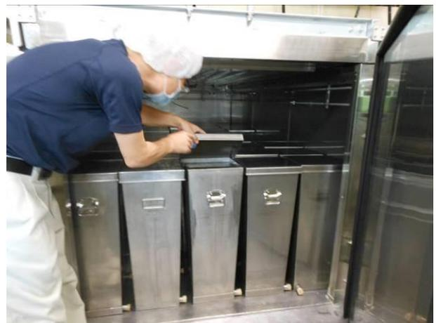
図 6. 結晶成長をさせる缶と保温室
