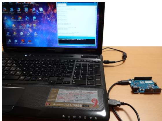
写真11: PC からスケッチを Arduino に USB 転送
