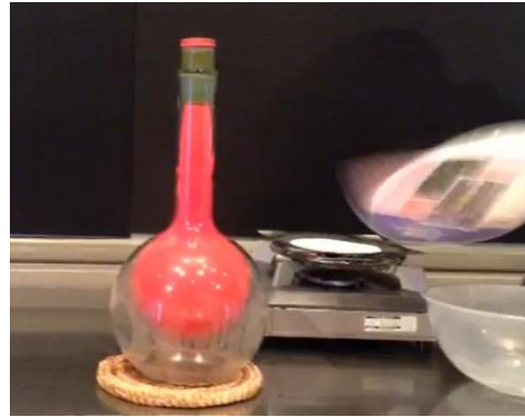
図9. お湯を捨て、風船でフタをして冷やすと、風船がフラスコの内側に入り込む。水蒸気が水になるときは体積が小さくなる。また空にしたはずのフラスコにスプーン1杯程度の水があることを確認することも大切。
