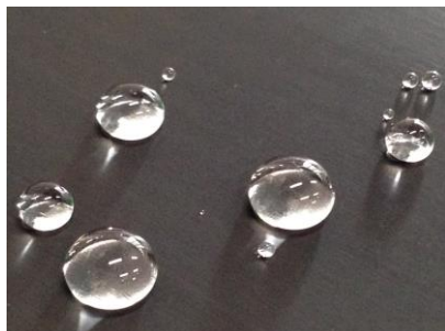
図1. 撥水剤を塗ったボード上で撥水した水。ただし水滴が小さいのでモニタに写して見せた。
