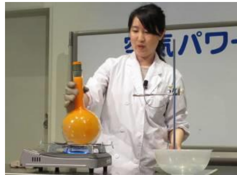
図10. 図9の状態再び加熱する。風船が戻っていき、フラスコの中のわずかな水はなくなる(水蒸気になる)ことを確認。
