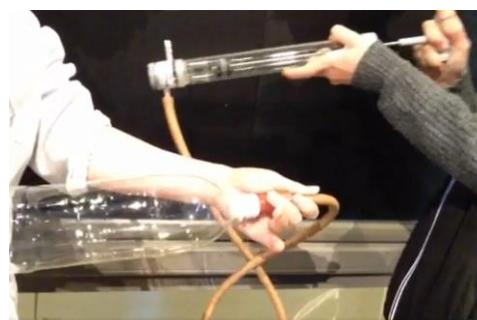
図5. PETボトルに雲を作る。PETボトルに水蒸気が入った空気を入れ(普通の空気)、断熱膨張のしくみを使って冷やし、小さな水滴(雲)に変化させる。
