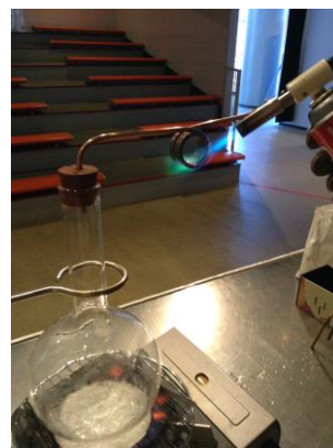
図4. 湯気と水蒸気、過熱水蒸気の実験道具。ゴム栓に銅管を取り付け、バーナーで加熱したり、霧吹きで水をかけて冷やしたりして、水蒸気と湯気を交互に見せる。
