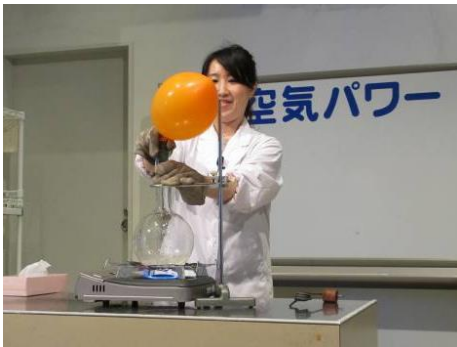
図7. 水を加熱しているフラスコに風船をとりつけると、水蒸気で風船が大きくふくらむ。水はほとんど減っていないのに、風船がかなり大きくなることに気付かせ、約1700倍になることを印象付ける。
