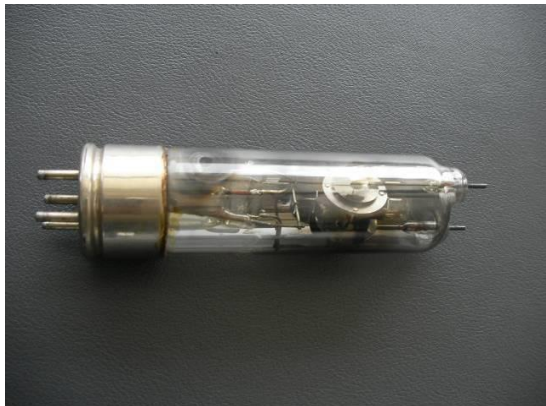
MX-11と名付けられた真空管。ネット等で調べて見たが何も引っかからない。竜胆型の分割陽極がある。これもマグネトロンだと思われる。
