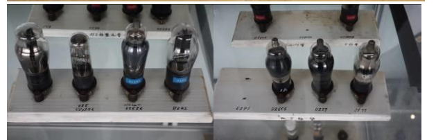
MX-11と名付けられた真空管。ネット等で調べて見たが何も引っかからない。竜胆型の分割陽極がある。これもマグネトロンだと思われる。
