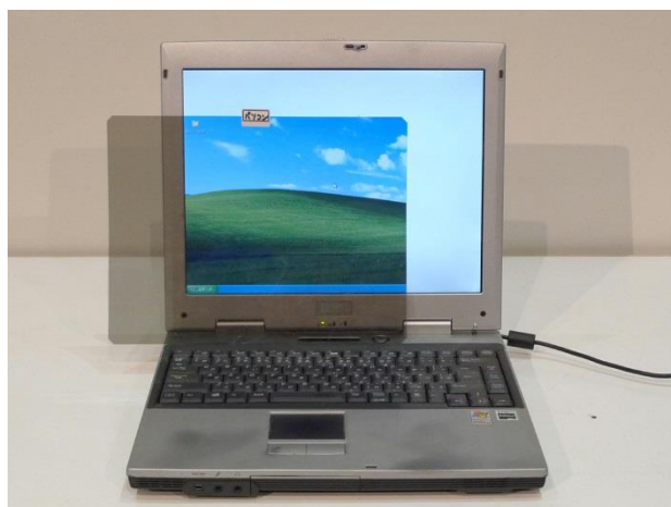
写真9. 偏光板を剥がしたノートパソコン
