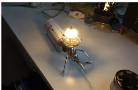
さらに、ガスの炎の中にマンツルの切れ端を入れ、白く輝く様子も見ていただいた。また、ガスランタンを実際に灯してもみた。明るさをガスコンロやガストーチと比較するために、カセットコンロと同じガスボンベを使用するガスランタン(新富士(SOTO)ST-260)を実験に使用した。
