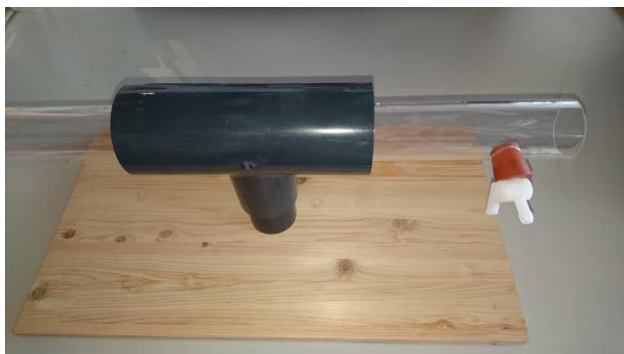
図1. アクリルパイプの T 字管取り付けと、二方コック取り付け部
