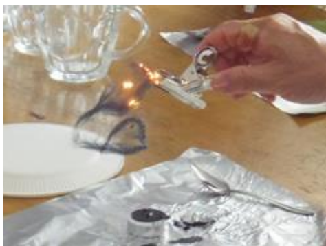
図13. 「鉄は燃えるのか？」の実験。ふわふわの鉄「スチールウール」を加熱する。
