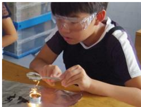
図14. 「鉄は燃えるのか？」の実験。鉄粉を振りかけて、美しい光を観察した。
