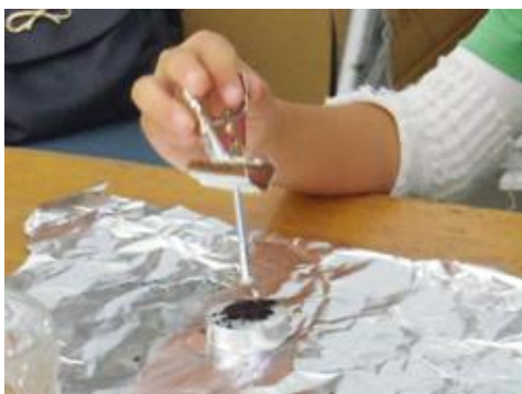
図12. 「鉄は燃えるのか？」の実験。倒れないように底面積の広いロウソクを使い、火でネジを加熱する。火バサミは高価なので、大きめのクリップをで代用。
