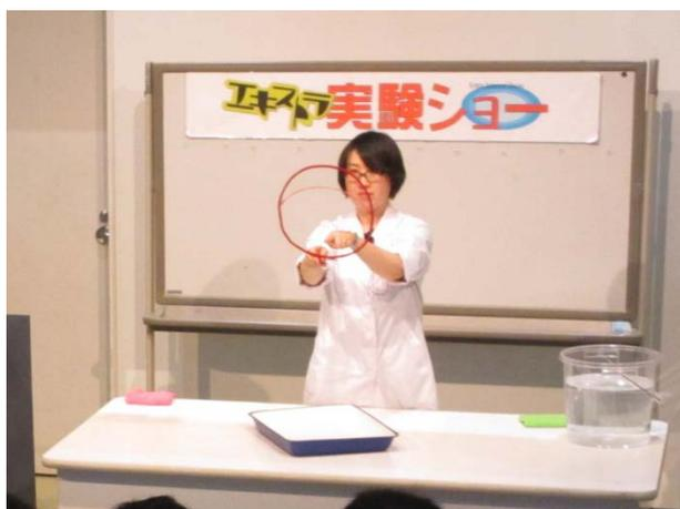
図3. 大きめの丸いシャボン玉枠の真ん中に糸を1本結び、シャボン膜を張ったあとに指で糸の下の膜だけを割った。表面張力によって、糸は上にあがる。
