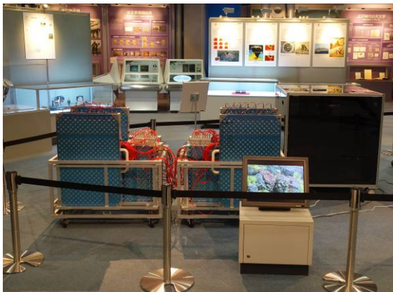
写真 2: 3 台並列運転したミュオグラフィ装置。奥の青い装置 2 台と黒い装置 1 台がミュオグラフィ装置で、手前のモニターは解説 DVD を流した。
