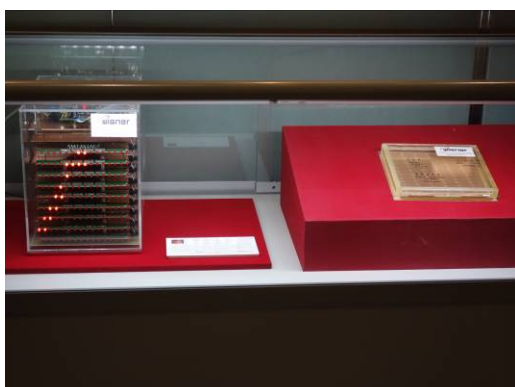
写真 5: MWPC (ワイヤーチェンバー) (左) とワイヤーチェンバーの模型 (一層) (右)
