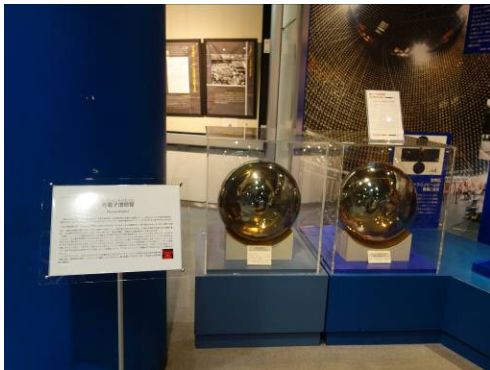
写真9：カミオカンデ(左)とスーパーカミオカンデ(右)のPMT。手前が追加した
