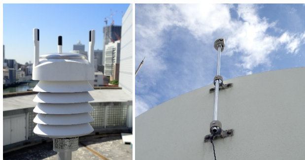
(左)写真1. ウェザートランスミッターWXT520 (右)写真2. 設置後の様子
