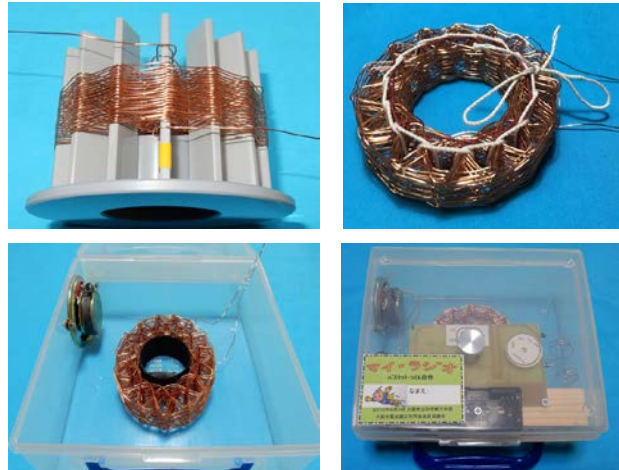
写真15. バスケットコイル完成品と完成したラジオ
