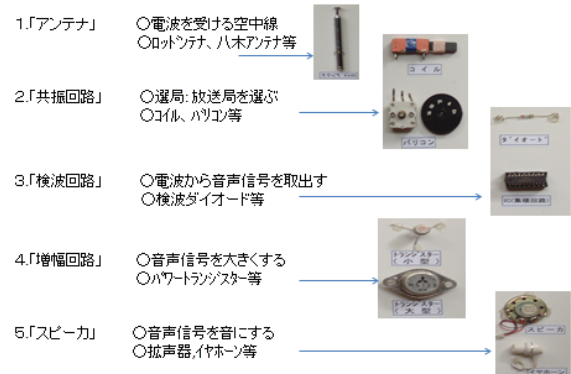
図2. ラジオ受信機の構成説明図
