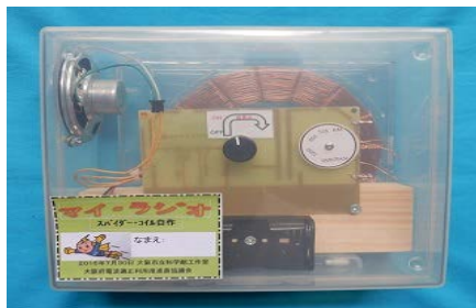
写真18. スパイダーコイルを用いて完成したラジオ
