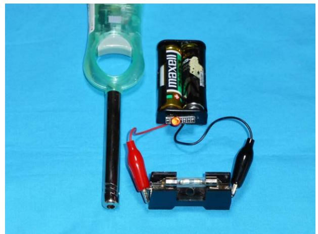
写真25. 現代のコヒーラを用いた実験
