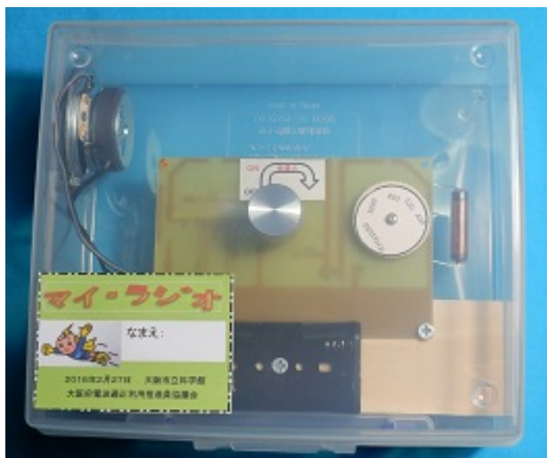
写真12. ラジオ基盤をケースに収め、組立て完了
