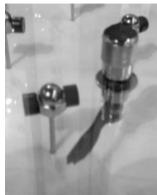
図7. 製作品(左)と外部から回転を与える機構(右)
