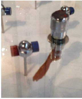
図3. 板ゴムで磁気回転子を回転させる機構
