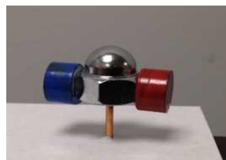
図 2. 袋ナットを用いた磁気回転子
