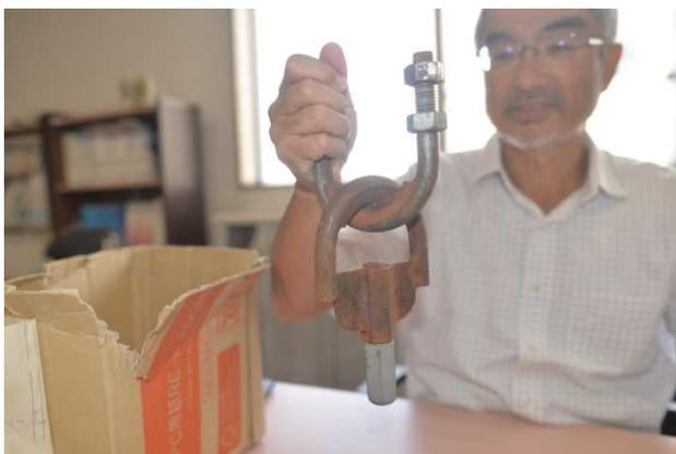
図7. 弘前大学で最初に設置されたフーコー振り子の自作支持部と設置を企図した宮永先生
