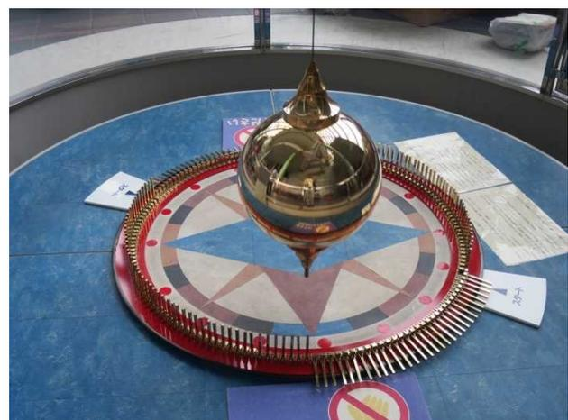
図6. 姫路科学館のフーコー振り子。カリフォルニア科学アカデミーのキット。キット価格は500万円程度。錘は100kg近くと重く、安定して振動し続けるが、ワイヤーに連続的に当たる風には弱い。
