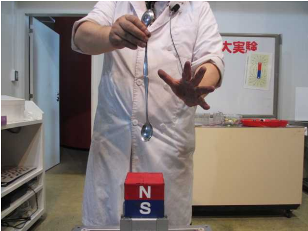
写真9. 向きの揃った磁石片に引き寄せられる(撮影用にカバーを外している)
