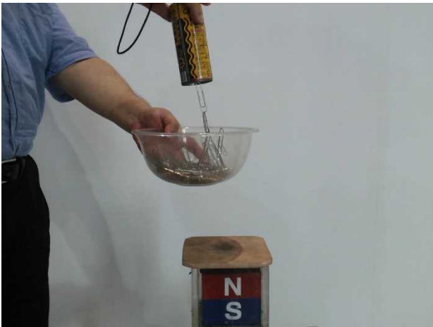
写真7. 向きの揃った磁石片に引き寄せられるクリップ
