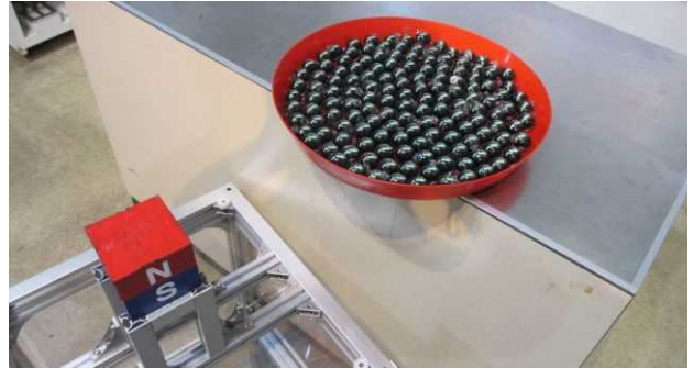
写真8. スーパー磁石の磁場で同方向を向いたコンパス。撮影用にスーパー磁石のカバーは外してある。
