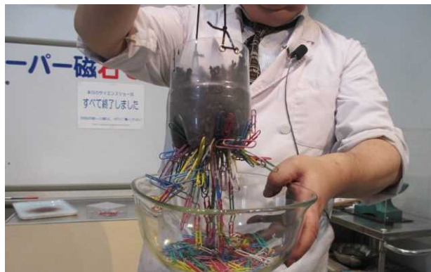
写真5. 向きの揃った磁石片に引き寄せられるクリップ
