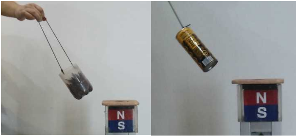
写真6. スーパー磁石に引き付けられる磁石片(左)とスチール缶(右)
