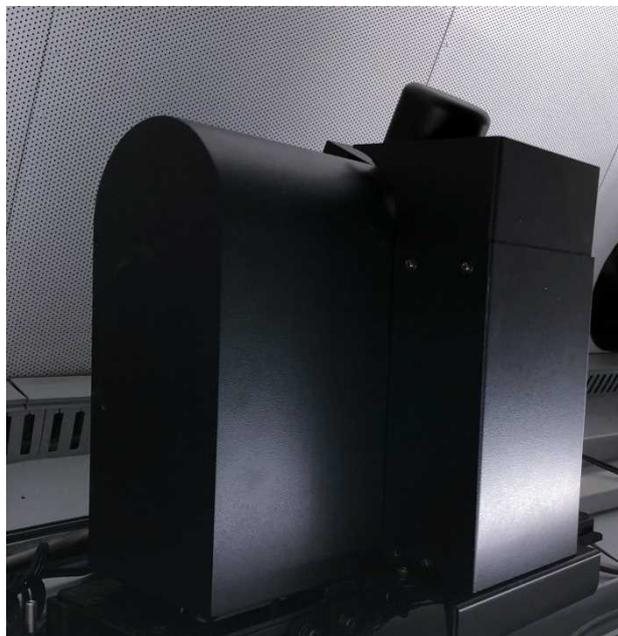
図 7. ドーム上部に設置された世界初の超新星投影機。強力なレーザー光源を使用。RGBで色・明るさ指定可能。日周などの運動に連動する。
