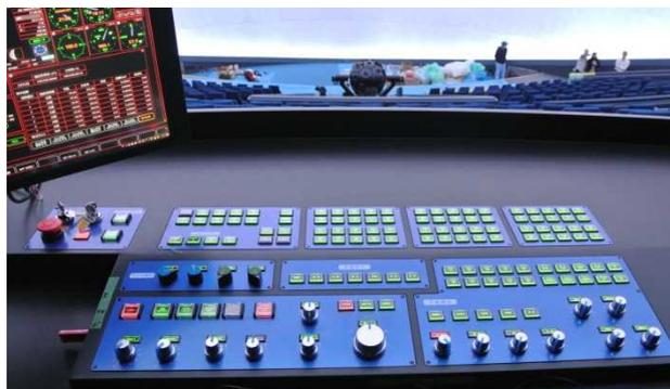
図 8. コンソール、マクロダイヤルは左下の 4 つ。マクロボタンも増やした。操作性は可能なかぎり継承。
