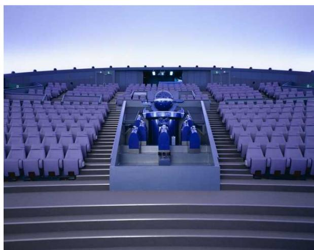
図 1. 今回のリニューアル前のプラネタリウム。傾斜ドームの中央にプラネタリウムが設置され、その背後にオムニマックス映写機、さらにドーム縁に 6 台のプロジェクターからはデジタル全天周映像システムの映像が映写される。
