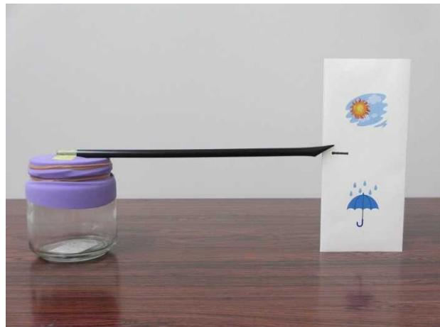
写真7 完成した気圧計
