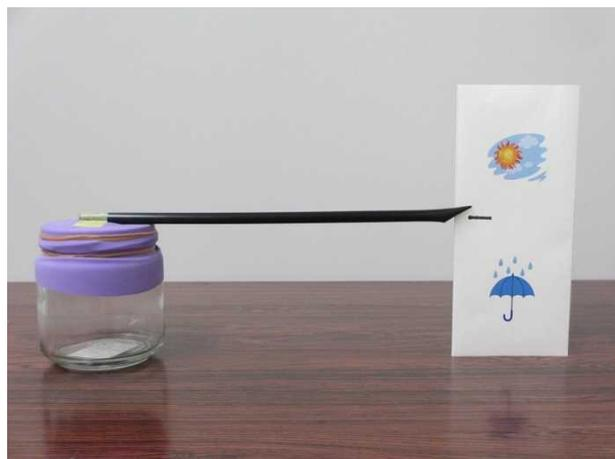
写真7 完成した気圧計
