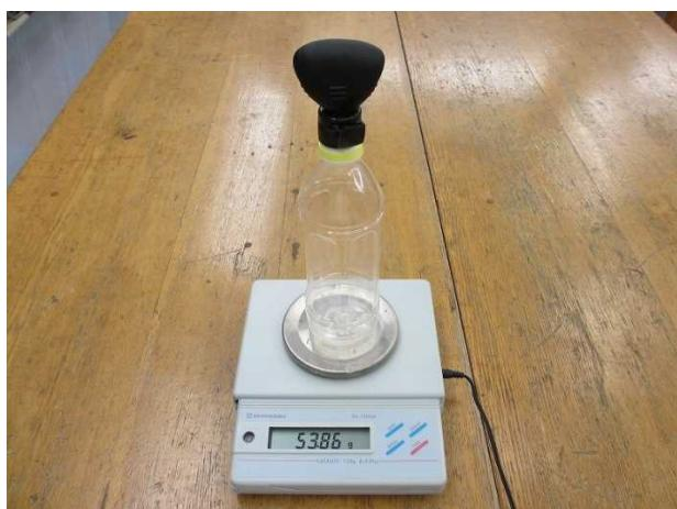
写真1 空気の重さの測定
