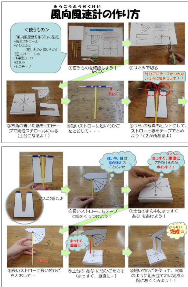
図2. 風向風速計の作り方
