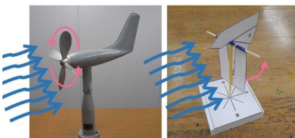
図1. 実物(左)と作成(右)した風向風速計
