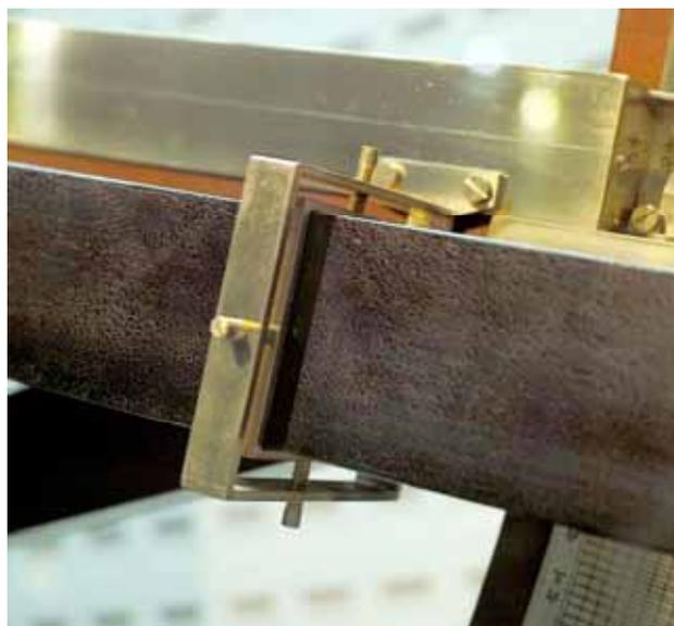
写真4. 中象限儀の視準望遠鏡取り付け部
