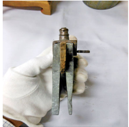
銅の缶の中にある亜鉛版。厚みは、最大6mm、最も薄いとこで2mm。
