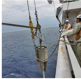
写真2 ロープで吊り下げられているピストンコアラ。
