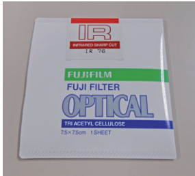
写真3. 赤外線透過フィルター。カメラ店、ネットで買えます。ある波長以下の可視光をカットし、赤外線を通します。
