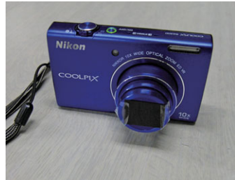
写真4. 写真3のフィルターをはさみで切って、カメラのレンズ前に赤外線透過フィルターをテープで貼り付けた。
