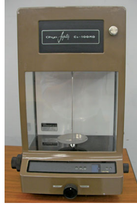
写真1 直示天秤C3-100MD (長計量器製作所製)
