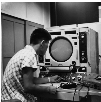
当時のレーダー受信装置:操作をしているのは筆者。無線電話のマイクロフォンなども写っている。
