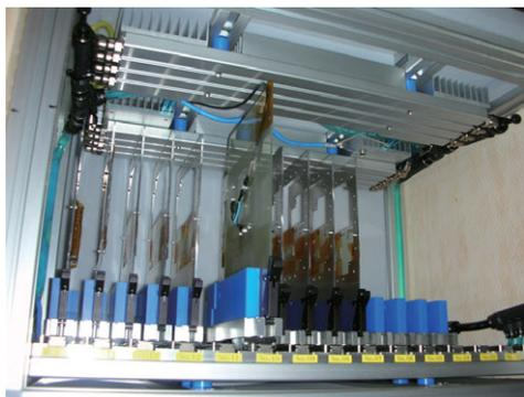
そこで、様々なデザインのセンサーに放射線を浴びせ、放射線量に対する性能の変化を調べて、放射線耐性の強いセンサーのデザインを選ぼう、というのが今回の試験の目的です。写真に写っているのはセンサーを保持する架台で、センサーは穴のあいたアルミ板に貼り付けられています。ビームを止めても放射線レベルが高く実験室にす
