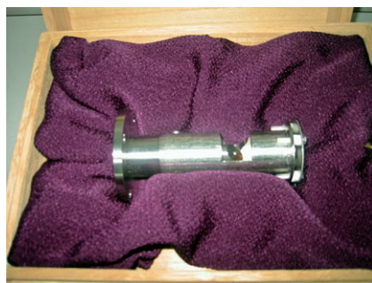
田中耕一さんの発明した質量分析器の心臓部、試料をイオン化する部分
